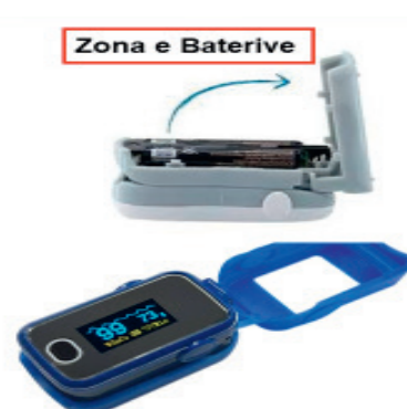
Skematika e një puls oksimetri dhe pjesëve përbërëse të tij
